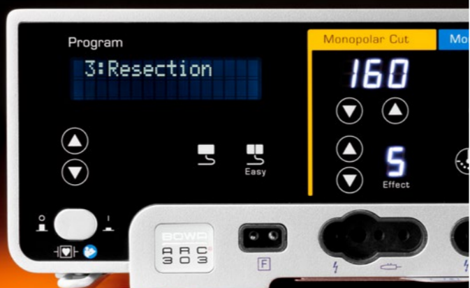
La gamme « résection » permet l'utilisation de 300 W pour la vaporisation avec des résectoscopes monopolaires.
