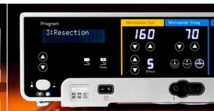
La gamme « résection » offre un pré-réglage pour l'utilisation de résectoscopes monopolaires ou d'hystérosopes jusqu'à max. 250 W
