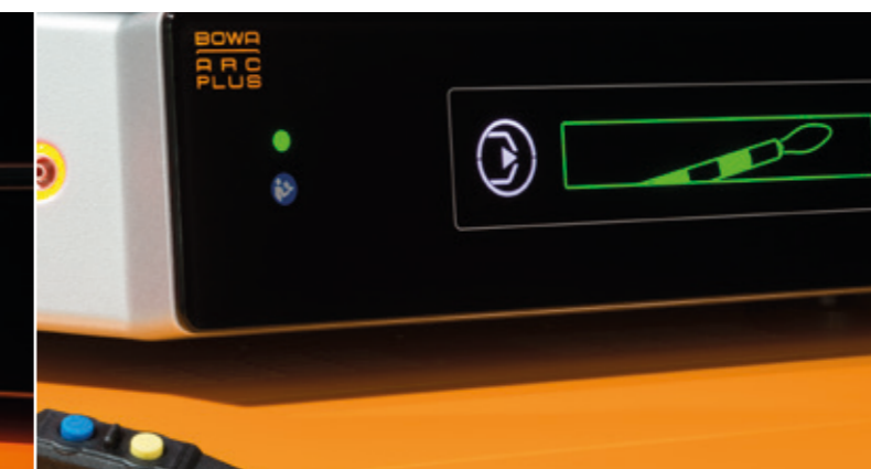
L'affichage vert signale le pré-rinçage (argon) des instruments connectés
