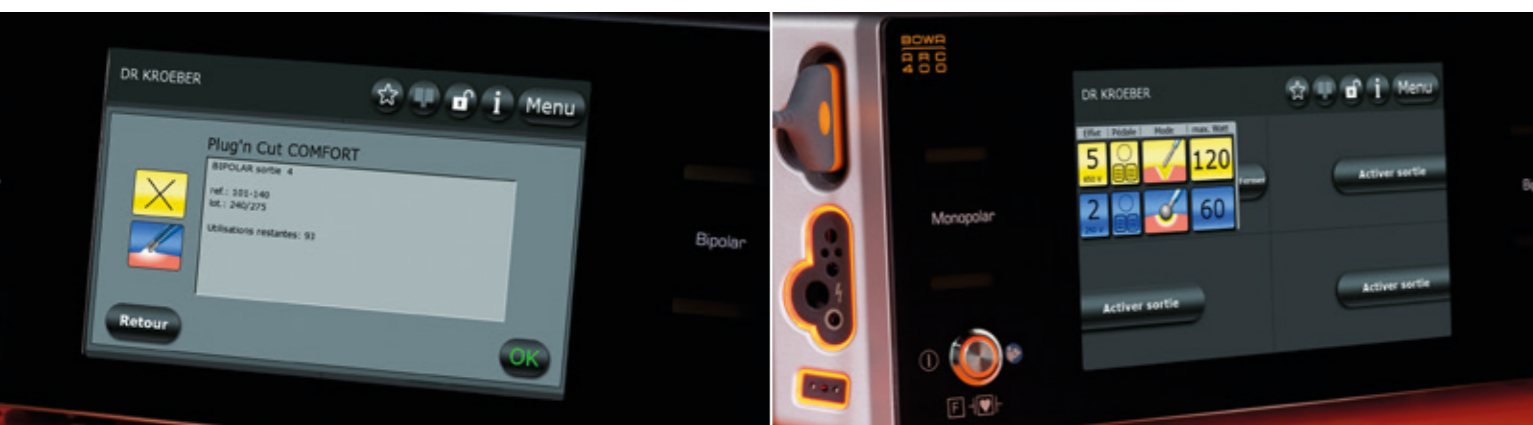
Plug'n Cut COMFORT : Le SYSTÈME COMFORT détecte automatiquement l'instrument COMFORT, indique le nombre d'utilisations pour lequel il est prévu, et présélectionne les paramètres appropriés au but d'utilisation.
